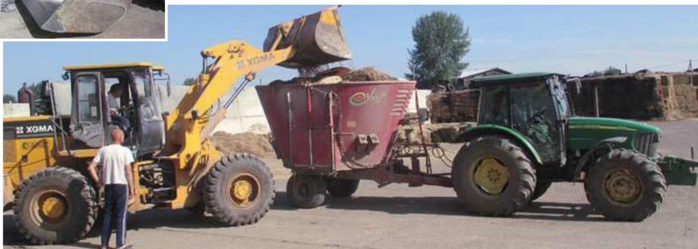
Рис. 1. Подготовка кормовой смеси (монокорма) в мобильных измельчителях-смесителях (ООО «Агрофирма «Заря», Нижегородская область)
