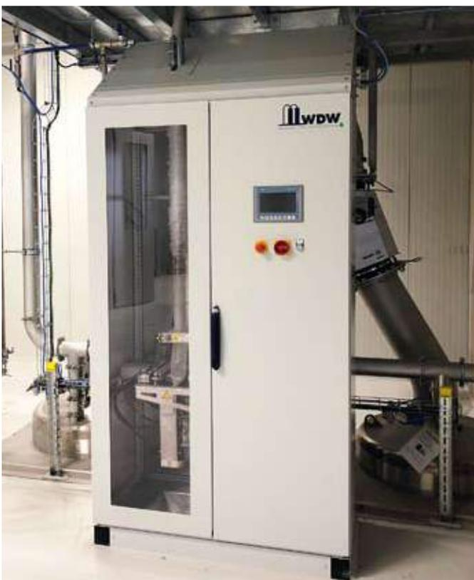
Рис. 3. Шкаф автоматического отбора и расфасовки проб EasyCollect
