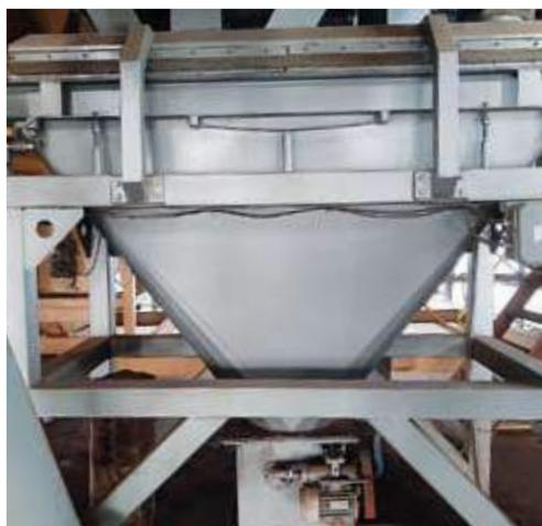
Рис. 2. Весы порционные тензометрические ДРОВ-1.01
