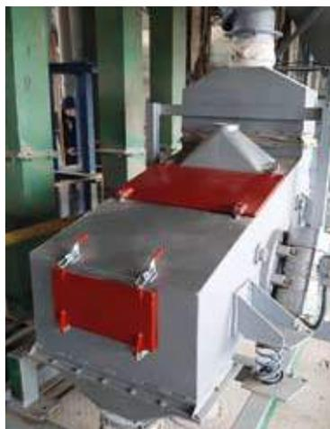
Рис. 6. Просеивающая машина ДРОМП-1
