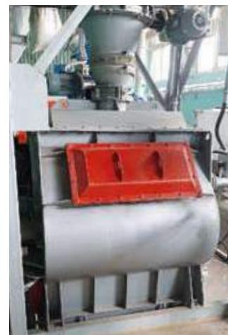
Рис. 7. Смеситель вакуумный ДРОСВ-1
