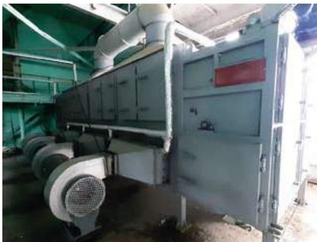
Рис. 5. Сушилка конвейерная ДРОСК-1
