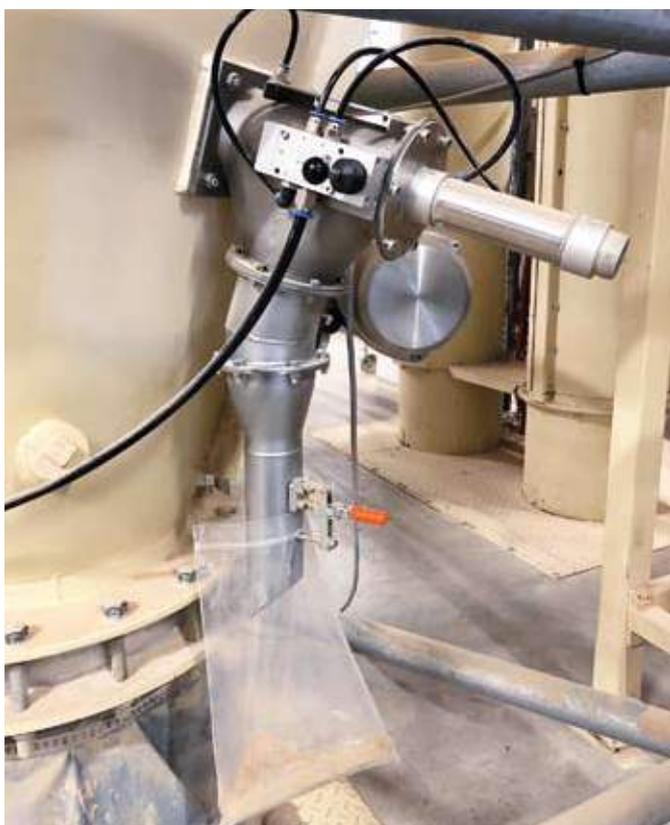
Рис. 1. Ручной отбор пробы из бункера пробоотборником PN Flow
