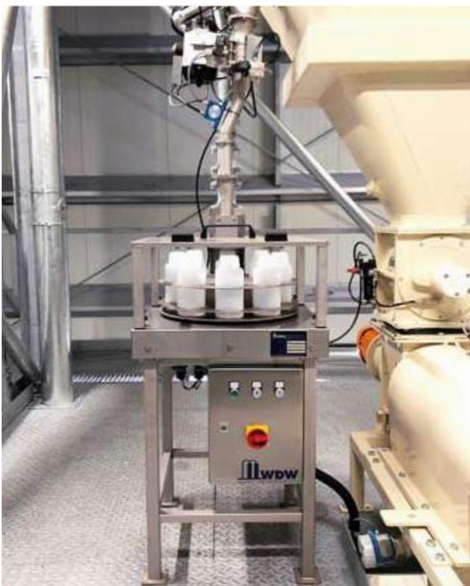
Рис. 2. «Карусель» RotareCollect для отбора проб
