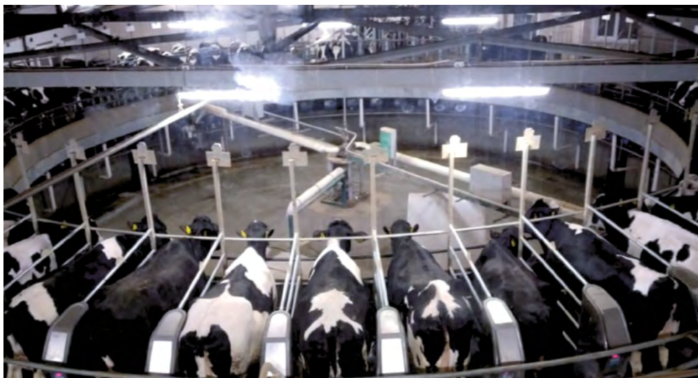
Дойный зал типа «карусель» производства компании GEA
