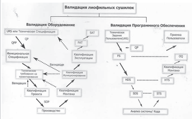
Рис.1. Валидация лиофильного оборудования. Fig. 1, Validation of freeze dryers
